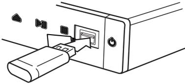
Bei Anschluss eines USB-Gerätes bei eingelenndem Hauptmenü werden auf dem USB-Speichergerät enthaltene Musikdateien automatisch wiedergegeben. Falls auf dem USB-Speichergerät verschiedene Dateitypen gespeichert sind, wird ein Menü zur Auswahl des Dateityps eingelenndet.
