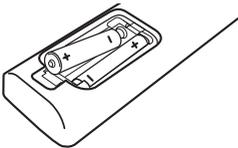
Nehmen Sie die Batterieklappe von der Rückseite der Fernbedienung ab und legen Sie zwei R03-Batterien (Größe AAA) mit der richtigen Polung  $\oplus$  und  $\ominus$  ein.
